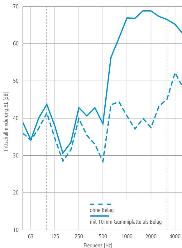
Messung der Trittschallminderung durch eine Deckenauflage auf einer massiven Bezugsdecke im Prüfstand in Anlehnung an EN ISO 10140. Messung im Akustiklabor der HBT-ISOL
