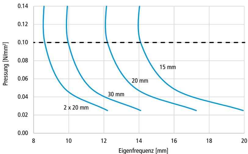
Eigenfrequenz des Systems bestehend aus
