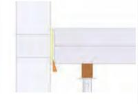
2 Positionner l'élément préfabriques avec la grue et le niveler sur des étais. Surélever de 3 à 4 mm le palier sur le côté de l'appui de la volée.
