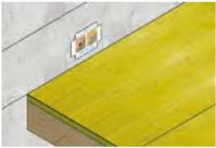
**2** Coffrer le palier. Retirer l'autocollant de protection du boîtier.
