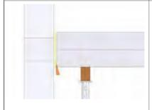
2 Positionner l'élément préfabriqué avec la grue et le niveler sur des étais. Surélever de 3 à 4 mm le palier sur le côté d'appui de la volée. Introduire ELKRAG entre l'élément préfabriqué et le mur.
