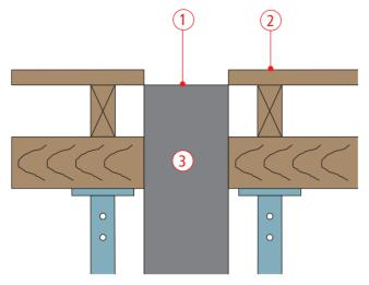
1. Montage sur pilier en béton La tête d'appui doit être parfaitement horizontale. La tolérance pour la face supérieure est de  $\pm$  1 mm par rapport à l'arête inférieure de la dalle. La résistance de la surface à la compression doit être de 15 N/mm².
