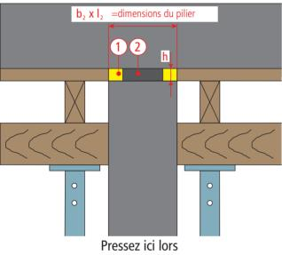
La plaque **ISOPREN**<sup>®</sup> (2) est posée à sec sur le support durci. Elle ne doit pas être aspergée d'huile de coffrage ou d'autres agents séparateurs.
