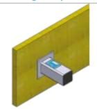
**1** Boîtier insonorisant fixé sur le coffrage. Variante mur en briques: emmurer le boîtier insonorisant dans le mur.
