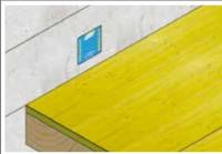
2 Monter le coffrage du palier. Découper l'autocollant de protection du boîtier insonorisant au niveau du passage de la broche.
