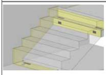
4 Colmater le joint entre la volée d'escalier et le mur limitrophe avec le profil de joint ISOSTRANG ou une band de rive avec ISOPE.
