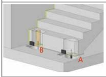
**2** Secteur pied de l'escalier, appui plat: l'appui d'escalier ISOTREPP est posé à sec sur un revêtement d'égalisation horizontal.
