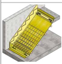
3 Coller la bande de rive ISOPE sur le mur pour la séparation latérale. Choisir une bande ISOPE suffisamment large pour qu'on puisse y tracer le développement complet des marches. Après la pose de l'armature et le coffrage des marches, l'escalier est bétonné.
