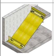
2 L'appui d'escalier ISOTREPP est posé à sec sur la base talochée et découpé dans le secteur des trous pour l'ISODORN. Ensuite, l'ISODORN est enfoncé jusqu'à la butée.
