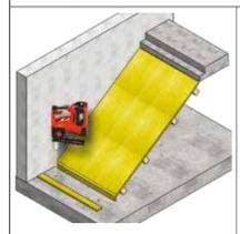
1 Après réalisation du coffrage de sous-couche, pour le montage de l'ISODORN, un trou de Ø 22 mm et d'une profondeur minimum de 80 mm est percé dans la dalle de fond et légèrement rempli de mortier de scellement.
