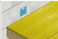
2 Monter le coffrage du palier. Découper l'autocollant de protection du boîtier insonorisant au niveau du passage de la broche.
