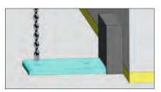
À travers les trous de l'équerre de sécurité, percer 2 trous de ø 10 mm et d'une profondeur de 90 mm dans la dalle de fond\*.
