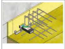
4 Introduire les étriers d'armature sur la broche, visser conformément à la marque de distance indiquée sur l'autocollant. Placer la bande de rive ISOPE. Fixer l'étrier d'armature avec l'armature.
