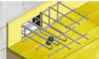
**4** Coller les bandes de rive ISOPE 20 sur le mur et découper le secteur du percement dans le boîtier insonorisant. Coller les extrémités et les joints dans le secteur du boîtier insonorisant avec de la bande adhésive étanche.
