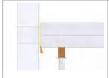
2 Positionner l'élément préfabriqué avec la grue et le niveler sur des étais. Surélever de 3 à 4 mm le palier sur le côté d'appui de la volée. Introduire ELKRAG entre l'élément préfabriqué et le mur.
