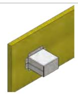
**1** Clouer le boîtier d'encastrement dans le bon sens sur le coffrage. Variante mur en briques: Emmurer le boîtier dans le bon sens dans la maçonnerie.
