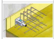
4 Introduire la gaine d'armature sur la broche, et la coller sur l'ELKRAG. Mettre en place les bandes de rive ISOPE-20. Fixer la gaine d'armature à l'armature.
