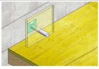
**3** Introduire la broches dans le boîtier insonorisant jusqu'à la butté/ au marquage. Découper ELKRAG, l'enfiler sur la broche et le coller sur le mur
