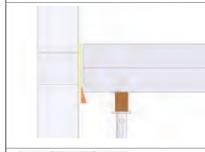
2 Positioner l'élement préfabriqué avec la grue et le niveler sur des étais. Surélever de 2 mm le palier sur le côté d'appui de la volée d'escalier. Introduire ELKRAG entre l'élément préfabriqué et le mur.
