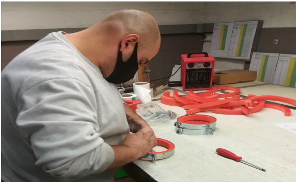
Der körperschalldämmende Polyurethanschaum-Ring der ISOSCHELL-Rohrschellen wird objektspezifisch auf Mass und Belastung ausgelegt und anschliessend gefertigt
