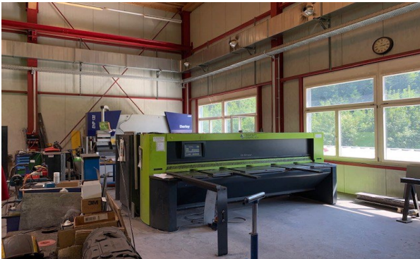
Hydraulische Tafelschere vom Typ Safan Darley-B-Shear 310-6
