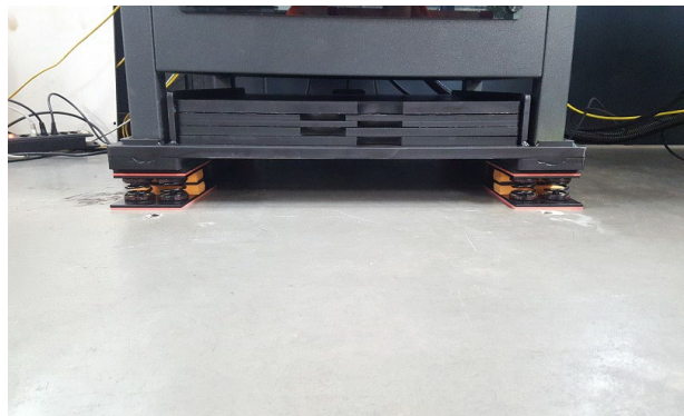
Beruhigungsmasse und Stahlfedersystem ISOFED®-SMALL-D
