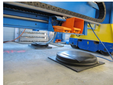
Les amortisseurs pneumatiques en caoutchouc sont en place. Au premier plan, un ISOAIR-580-HD supportant une charge de 51.5 kN – 104.0 kN.
