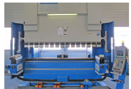
La presse-plierie repose sur son socle en acier, séparée et isolée de la structure du bâtiment. L'effet d'amortissement des appuis pneumatiques en caoutchouc ISOAIR est de 93%.
