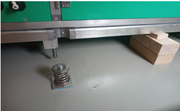
Einbauen der Stahl Druckfedern mittels Gewintheadaptern
