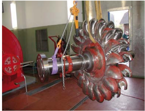
Abb. 2: Turbinenrad der alten Pelton-Turbine [4]
