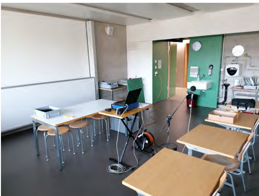
Schallpegelmessung im angrenzenden Schulraum
