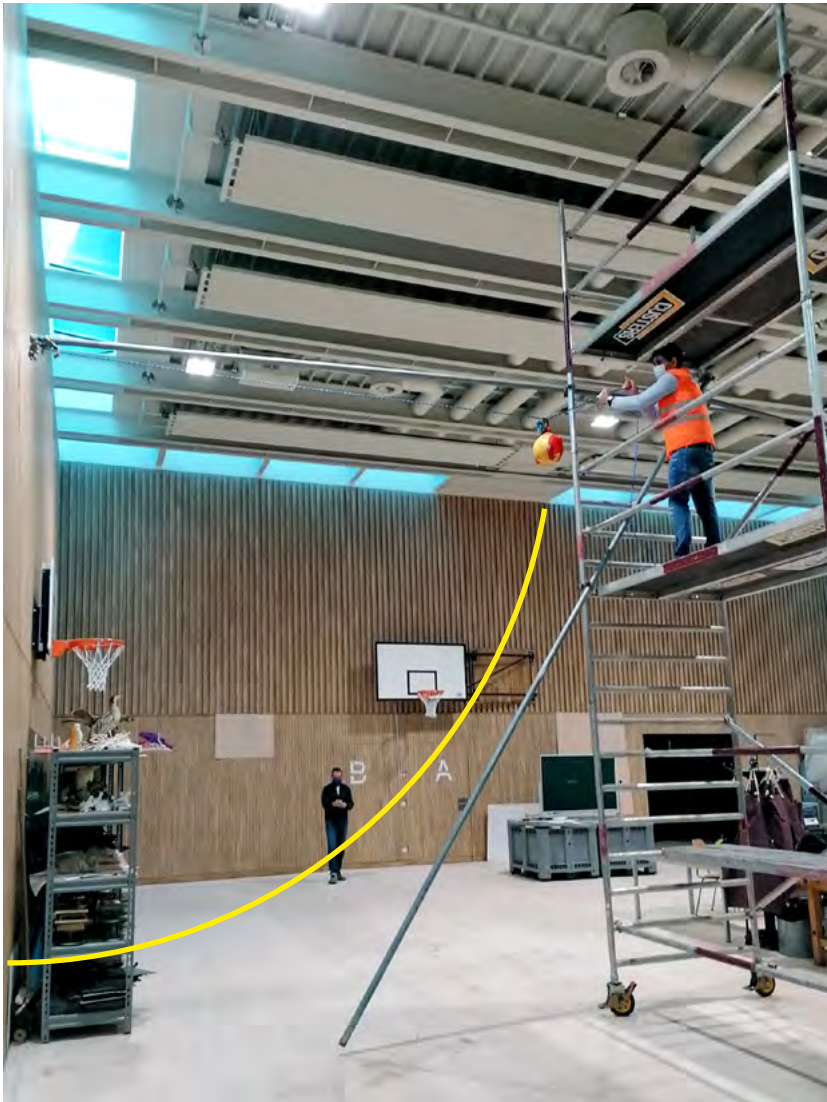
Pendelschlaganregung mit einem Medizinball, die gelbe Kurve zeigt die Ballbewegung.
