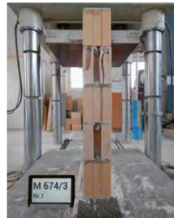
Dispositif de test p+f Sursee, Résistance à la compression de la maçonnerie
