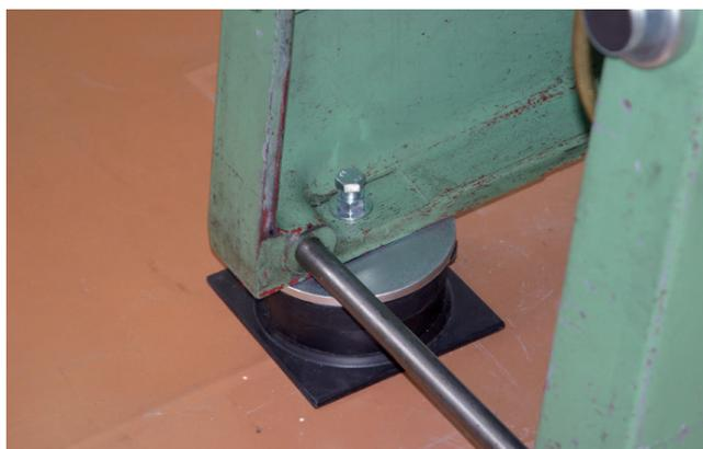
Stanzpresse direkt auf Gummiluftfedern ISOAIR aufgestellt.
