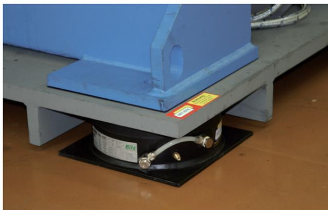
Stanzmaschine auf Stahlrippenplatte gelagert auf Gummi-Luftfedern ISOAIR.
