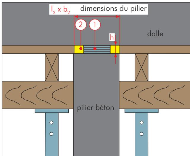
L'appui de déformation **DINBLOCK-DB** (1) est posé à sec sur le support durci. Les appuis de déformation **DINBLOCK-DB** ne doivent pas être aspergés d'huile de coffrage ou autres agents séparateurs.
