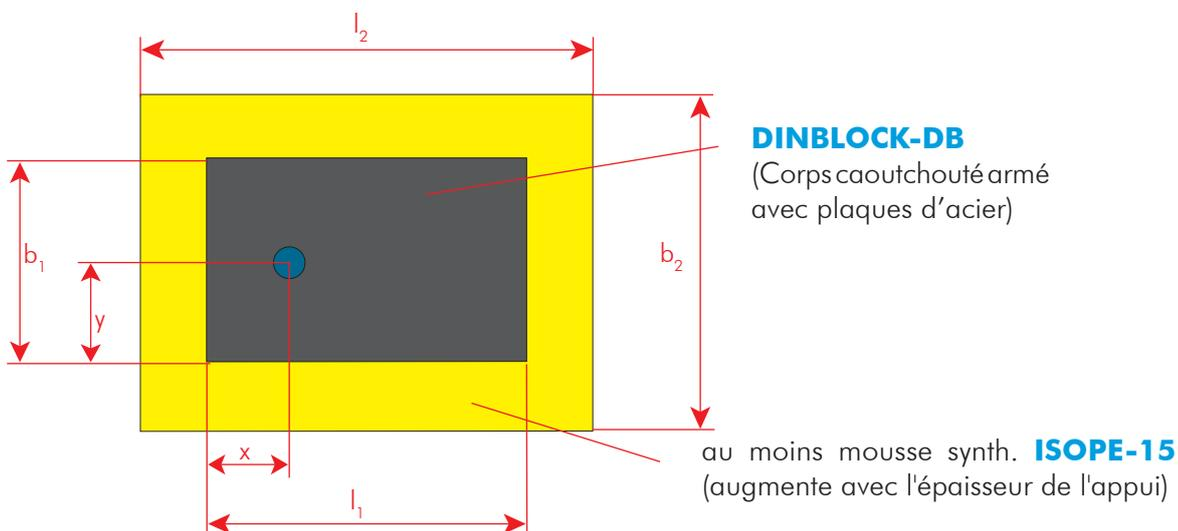
x: Distance du trou au bord dans la longueur de l'appui
