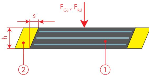
1. Corps caoutchouté **DINBLOCK-DB** armé avec plaques d'acier
