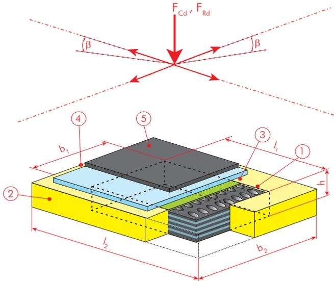
1. Corps caoutchouc armé avec plaques d'acier
