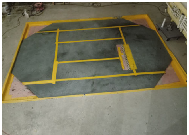
8-Eck-Wanne: Lagerung mit einem Massefundament aus Stahlplattensegmenten für wenig Aufbauhöhe
