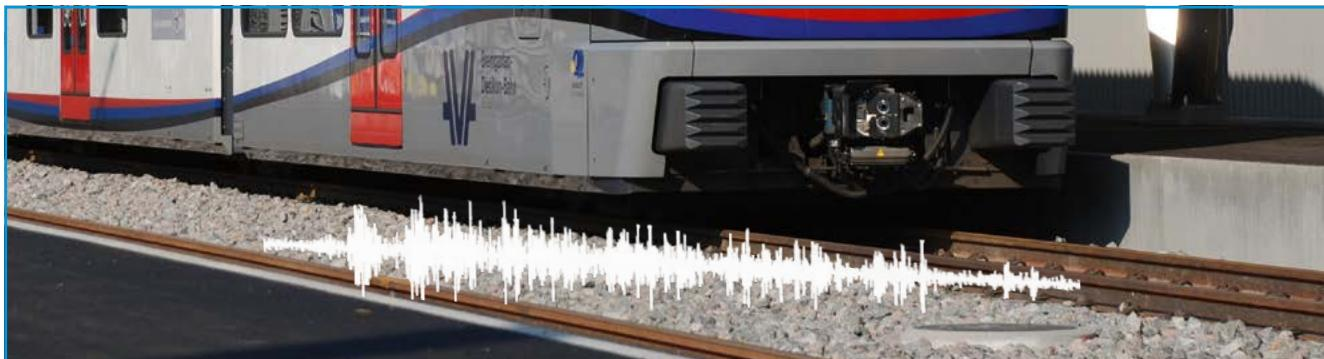
Les convois ferroviaires en circulation génèrent des vibrations considérables, qui sont transmises par le sol dans les bâtiments adjacents en l'absence de mesures de protection. Ces énergies perturbatrices y sont perçues sous forme de bruits aériens secondaires comme des bruits audibles et des vibrations perceptibles.
