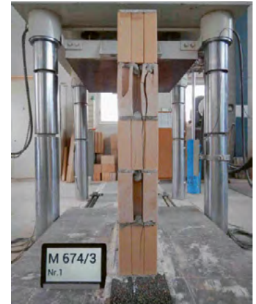
Prüfabau am p+f Sursee zur Druckfestigkeit des Mauerwerks.
