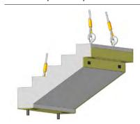
1 Sortie de volée: l'appui d'escalier ISOTREPP® est collé avant son installation sur la volée préfabriquée. Attention: les appuis doivent être collés bien à plat et ne pas présenter de vides entre appui et volée d'escalier.
