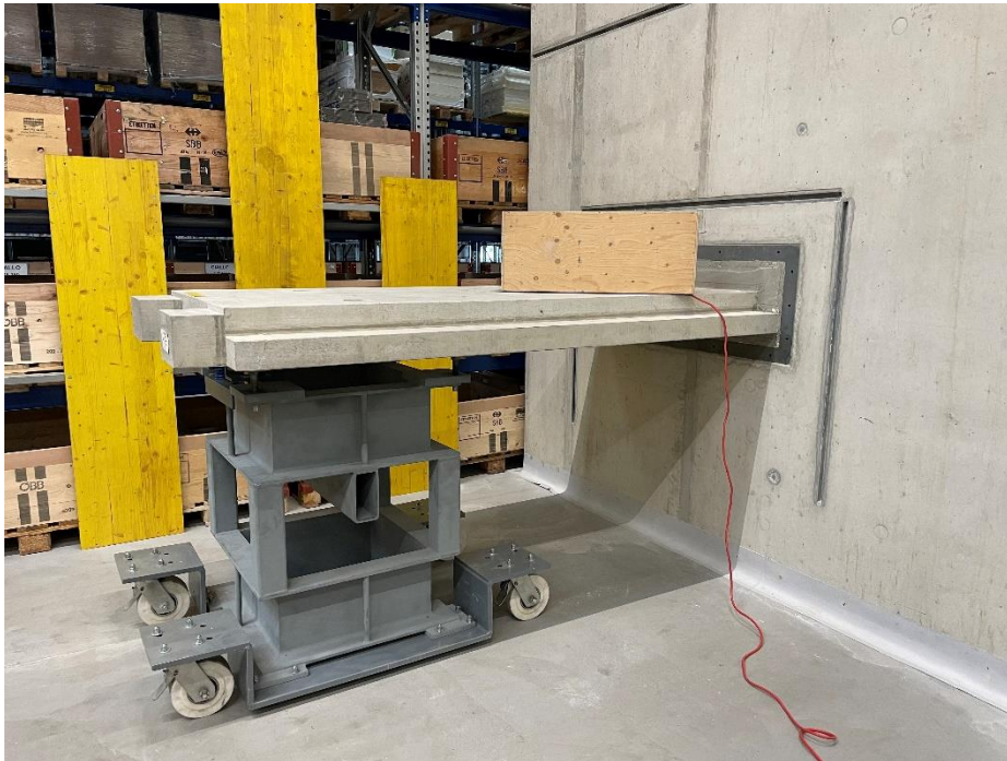
Abbildung 7: Trittschallmessung des starr angebundenen Podestes ( L_{n0,Podest} )
