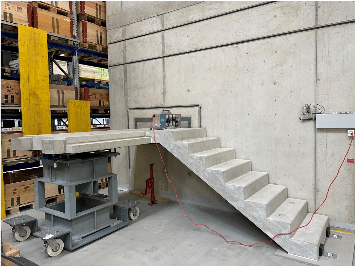
Abbildung 11: Trittschallmessung des mit Treppenlagern ISOTREPP® entkoppelten Treppenlaufes ( L_{n, \text{Lauf}} )
