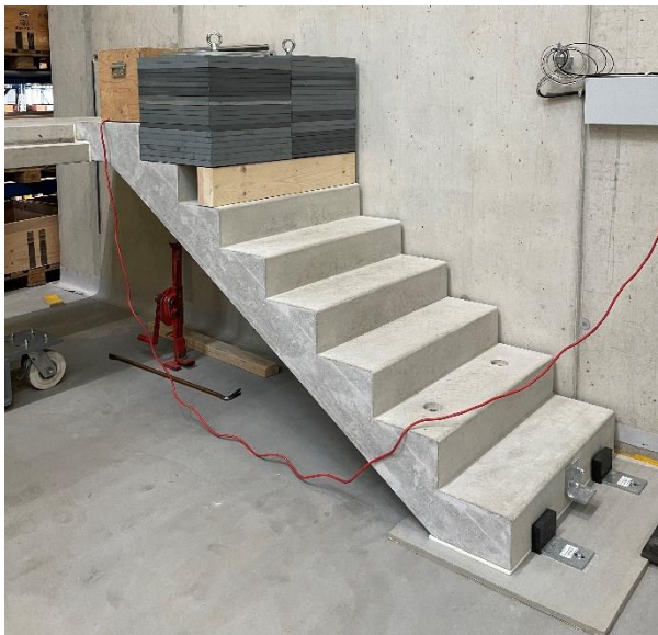
Abbildung 14: Aufbringung der Zusatzmassen mit Stahltürmen
