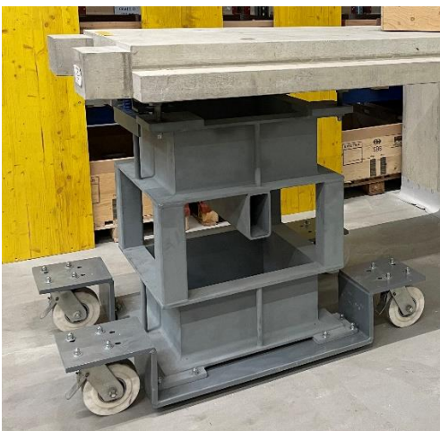
Abbildung 5: Montagewagen als Hilfswand
