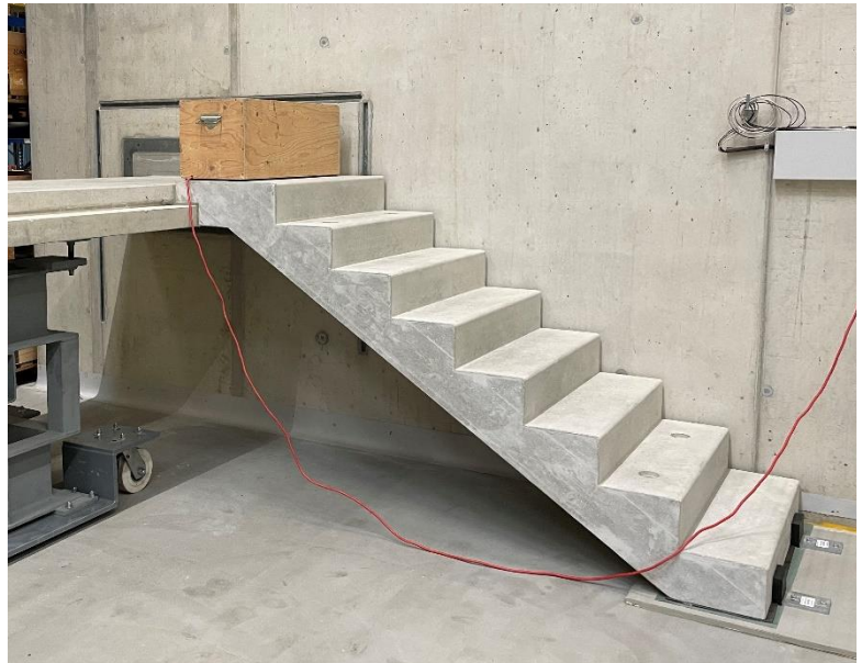
Abbildung 10: Trittschallmessung des starr angebundenen Treppenlaufes ( L_{n0, \text{Lauf}} )
