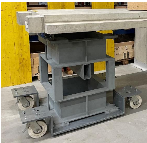
Abbildung 5: Montagewagen als Hilfswand
