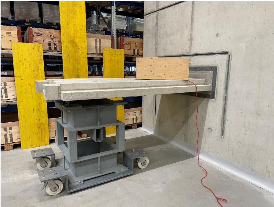
Abbildung 7: Trittschallmessung des starr angebundenen Podestes ( L_{n0,Podest} )
