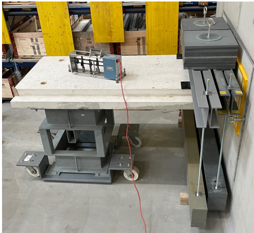
Abbildung 3: Aufbau Podest mit Podestlagern und Zusatzlasten
